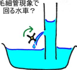
液体が登ってゆく現象は、液体ヘリウムよりもっと身近な所にもある。例えば毛細管現象だ。水面にストローを刺してみると、水はわずかながらストローの中を登ってゆく。このわずかに登ってきた水の力を利用することはできないだろうか。ストローに小さな穴を開けて、登ってきた水が外
